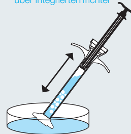
HYDRIEREN & HERAUSRÜCKEN überschüssiger Flüssigkeit (Kompression des Granulats vermeiden)
