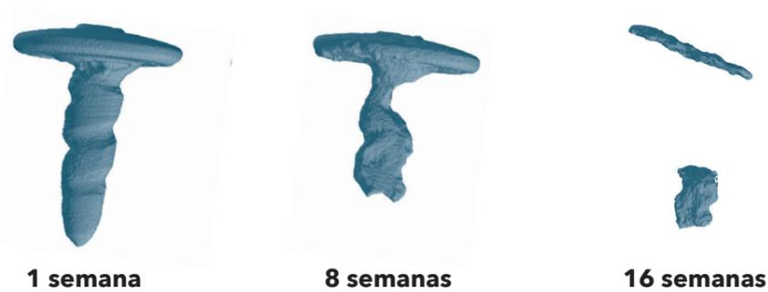
El tornillo NOVAMag® fixation screw XS se degrada gradualmente durante unas 16 semanas para proporcionar una fijación de membrana segura
